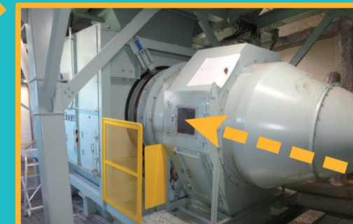
比重選別機(風力選別) 風の力(比重選別機用送風機)で、軽量系プラと重量系プラに選別。
