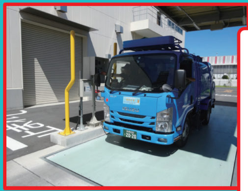
入口計量器で重さを測定。
